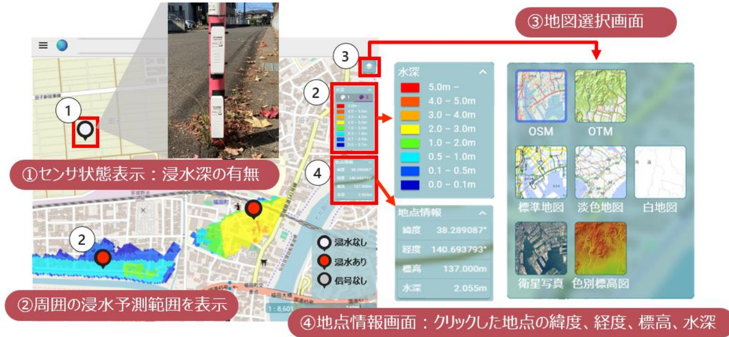
日立で実証した浸水センサ可視化システム
